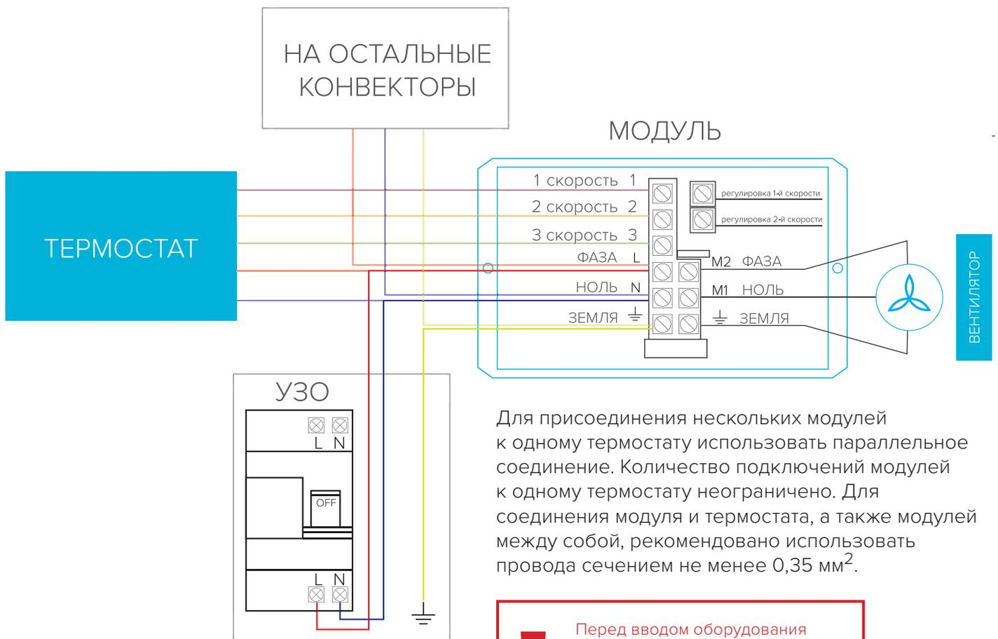
Для присоединения нескольких модулей к одному термостату использовать параллельное соединение. Количество подключений модулей к одному термостату неограничено. Для соединения модуля и термостата, а также модулей между собой, рекомендовано использовать провода сечением не менее 0,35 мм<sup>2</sup>.
